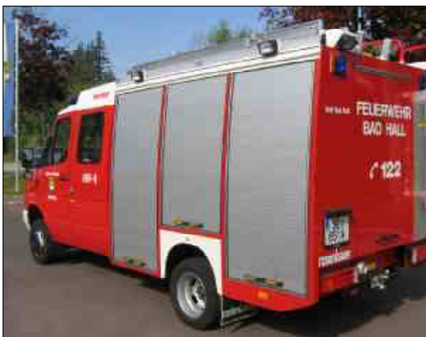
Das Fahrzeug in der Ansicht von hinten. Besonders hervorzuheben der optimierte Stauraum mit drei Geräteraumen auf jeder Seite.
