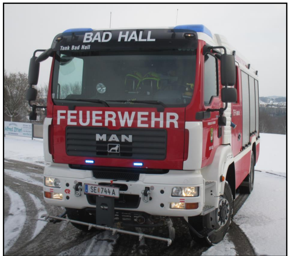
Hier die nachgerüstete Straßenwaschanlage
