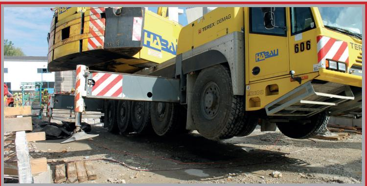
**Autokran in Schiefelage:** Ein Autokran geriet auf der Baustelle eines Industriebetriebs in Schiefelage, nachdem das Erdreich unter einer der Stützen nachgegeben hatte. Nach zeit- und materialintensivem Einsatz konnte der Kran wieder sicher aufgerichtet werden.
